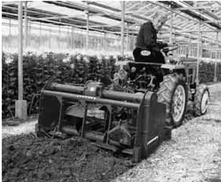
Fig. 2.2 Een spitmachine maakt een prachtig plantbed.
